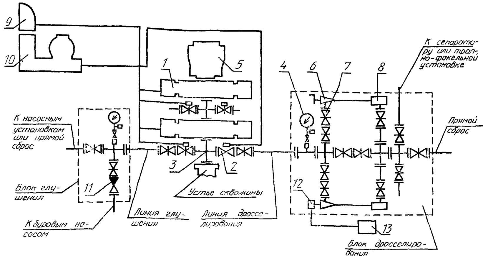
1 — плашечный превентор; 2 — задвижка с гидравлическим управлением; 3 — устьевая крестовина; 4 — манометр с запорным и разрядным устройствами и разделителем сред; 5 — кольцевой превентор; 6 — дроссель с ручным управлением; 7 — задвижка с ручным управлением; х — гаситель потока; 9 — вспомогательный пульт; 10 — станция гидропривода; 11 — обратный клапан; 12 — регулируемый дроссель с гидравлическим управлением; 13 — пульт управления гидроприводным дросселем
