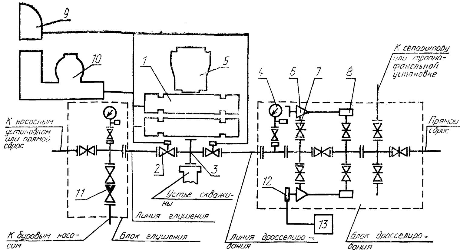
1 — плашечный превентор; 2 — задвижка с гидравлическим управлением; 3 — уставная крестовина; 4 — манометр с запорным и разрядным устройствами и разделителем сред; 5 — колцевой превентор; 6 — дроссель регулируемый с ручным управлением; 7 — задвижка с ручным управлением; 8 — гаситель потока; 9 — вспомогательный пульт; 10 — станция гидропривода; 11 — обратный клапан; 12 — регулируемый дроссель с гидравлическим управлением; 13 — пульт управления гидроприводным дросселем
