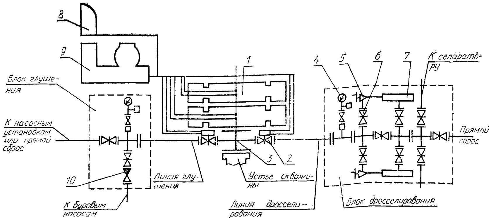
1 — плашечный превентор; 2 — задвижка с гидравлическим управлением; 3 — устьевая крестовина; 4 — манометр с запорным и разрядным устройствами и разделителем сред; 5 — дроссель регулируемый с ручным управлением; 6 — задвижка с ручным управлением; 7 — гаситель потока; 8 — вспомогательный пульт; 9 — станица гидравлического управления; 10 — обратный клапан
