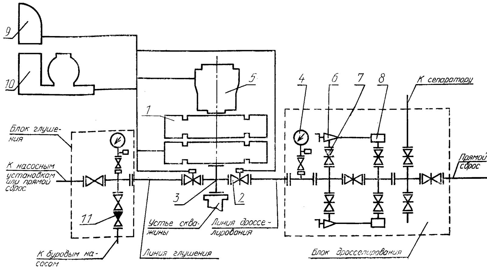
1 — плашечный превентор; 2 — задвижка с гидравлическим управлением; 3 — устьевая крестовина; 4 — манометр с запорным и разрядным устройствами и разделителем сред; 5 — кольцевой превентор; 6 — дроссель регулируемый с ручным управлением; 7 — задвижка с ручным управлением; 8 — гаситель потока; 9 — вспомогательный пульт; 10 — станция гидропривода; 11 — обратный клапан
