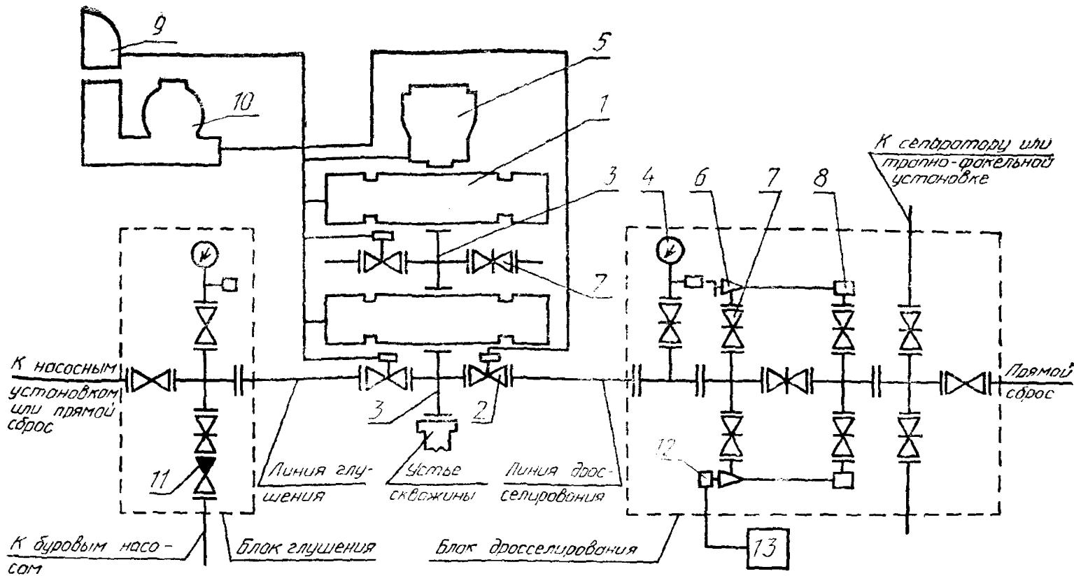
1 — плашечный превентор; 2 — задвижка с гидравлическим управлением; 3 — устьевая крестовина; 4 — манометр с запорным и разрядным устройствами и разделителем сред; 5 — кольцевой превентор; 6 — дроссель регулируемый с ручным управлением; 7 — задвижка с ручным управлением; 8 — гаситель потока; 9 — вспомогательный пульт; 10 — станция гидропривода; 11 — обратный клапан; 12 — регулируемый дроссель с гидравлическим управлением; 13 — пульт управления гидроприводным дросселем
