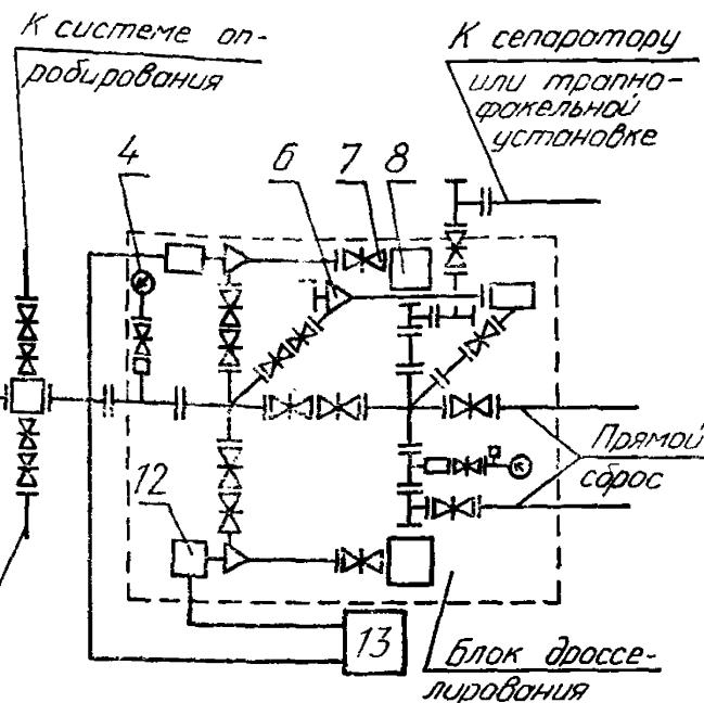
1 — плашечный превентор; 2 — задвижка с гидравлическим управлением; 3 — устьевая крестовина; 4 — манометр с запорным и разрядным устройствами и разделителем сред; 5 — кольцевой превентор; 6 — дроссель регулируемый с ручным управлением; 7 — задвижка с ручным управлением; 8 — гаситель потока; 9 — вспомогательный пульт; 10 — станция гидропривода; 11 — обратный клапан; 12 — регулируемый дроссель с гидравлическим управлением; 13 — пульт управления гидроприводным дросселем
