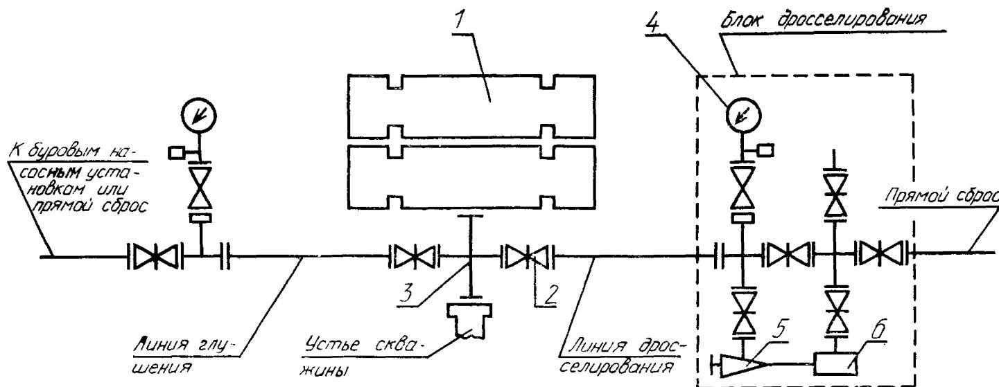
1 — плашечный превентор; 2 — задвижка с ручным управлением; 3 — устьевая крестовина; 4 — манометр с запорным и разрядным устройствами с разделителем сред; 5 — регулируемый дроссель с ручным управлением; 6 — гаситель потока
