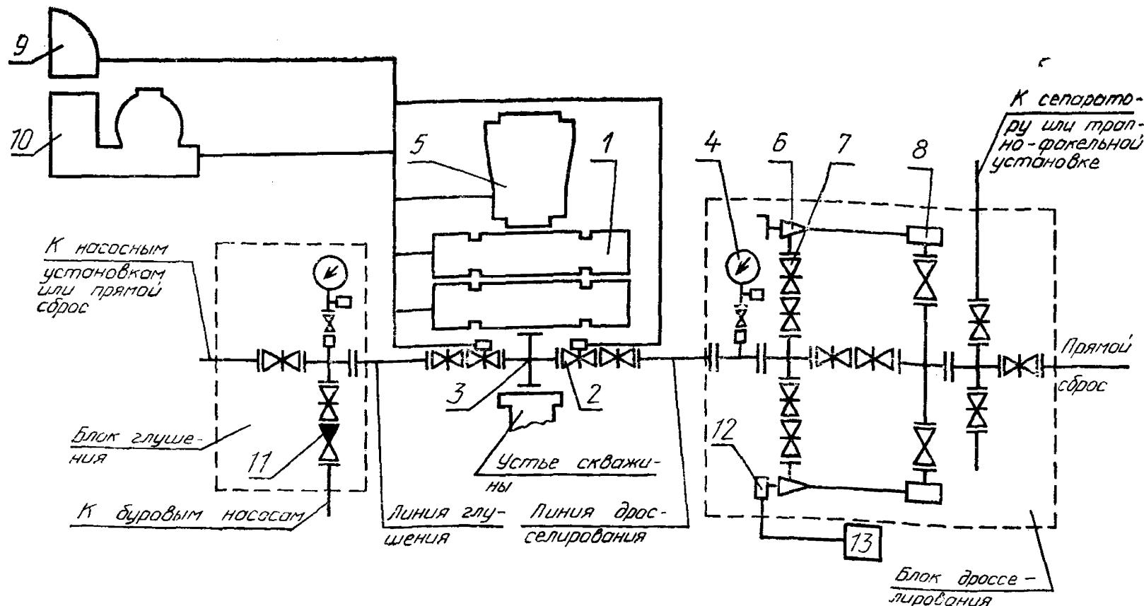
1 — плашечный превентор; 2 — задвижка с гидравлическим управлением; 3 — устьевая крестовина; 4 — манометр с запорным и разрядным устройствами и разделителем сред; 5 — кольцевой превентор; 6 — дроссель регулируемый с ручным управлением; 7 — задвижка с ручным управлением; 8 — гаситель потока; 9 — вспомогательный пульт; 10 — станция гидропривода; 11 — обратный клапан; 12 — регулируемый дроссель с гидравлическим управлением; 13 — пульт управления гидроприводным дросселем
