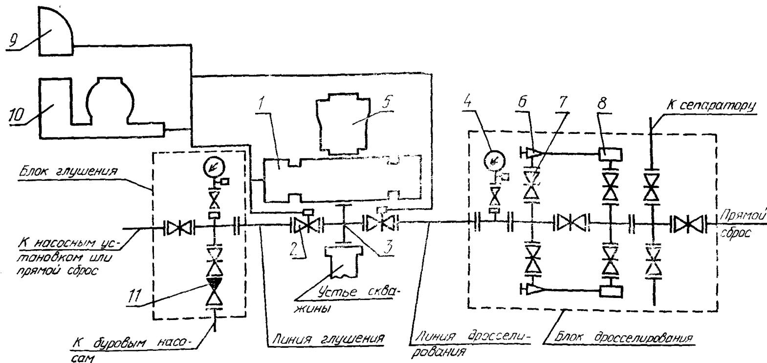
1 — плашечный превентор; 2 — задвижка с гидравлическим управлением; 3 — устьевая крестовина; 4 — манометр с запорным и разрядным устройствами и разделителем сред; 5 — кольцевой превентор; 6 — дроссель регулируемый с ручным управлением; 7 — задвижка с ручным управлением; 8 — гаситель потока; 9 — вспомогательный пульт; 10 — станция гидропривода; 11 — обратный клапан
