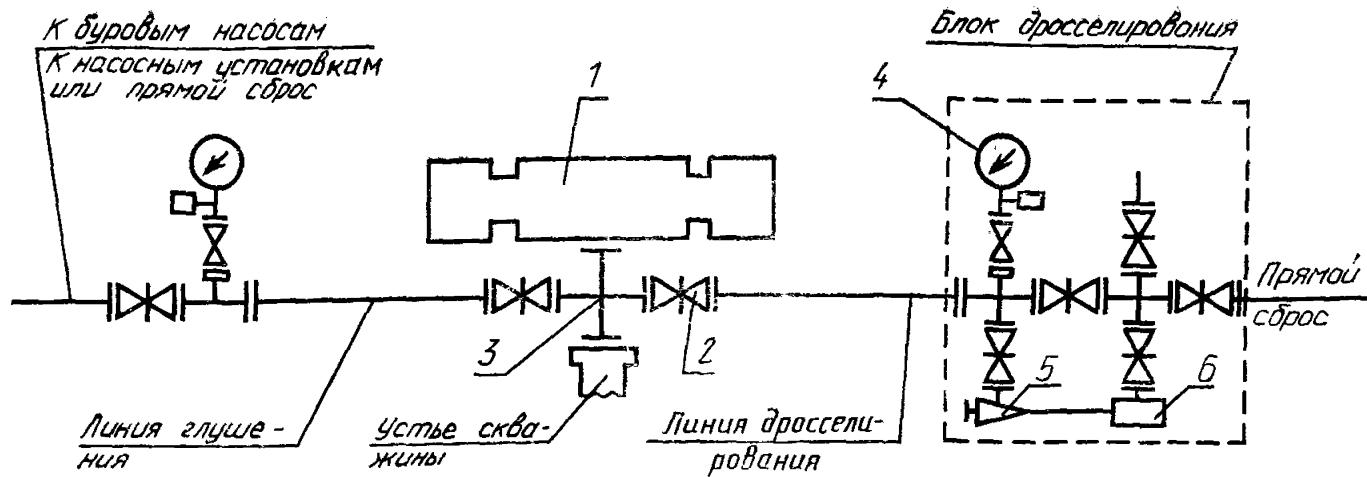
1 — плашечный превентор; 2 — задвижка с ручным управлением; 3 — устьевая крестовина; 4 — манометр с запорным и разрядным устройствами и разделителем сред; 5 — регулируемый дроссель с ручным управлением; 6 — гаситель потока
